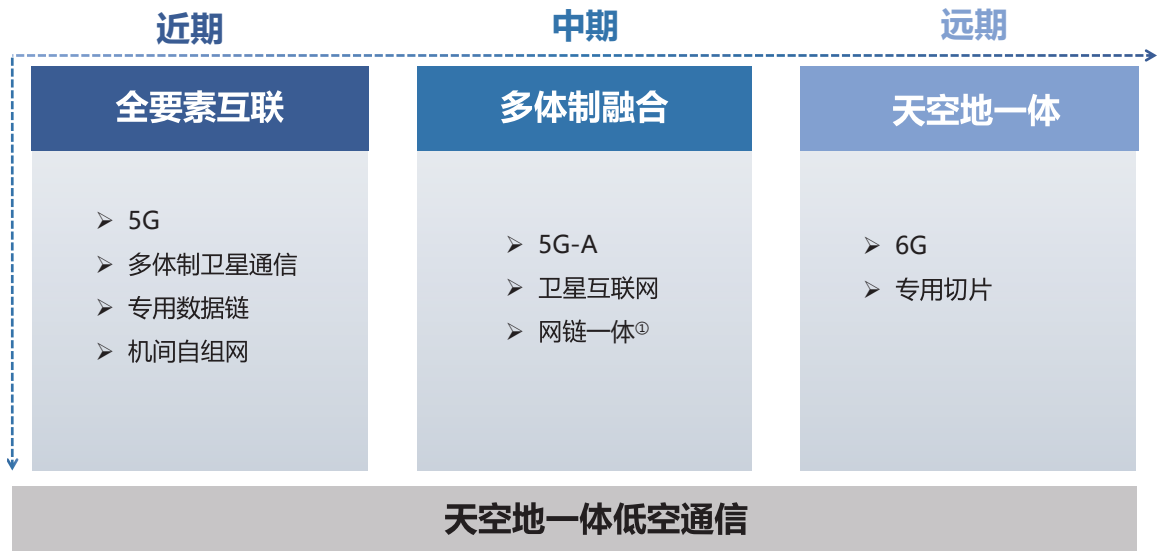
图9 低空通信技术演进路线
