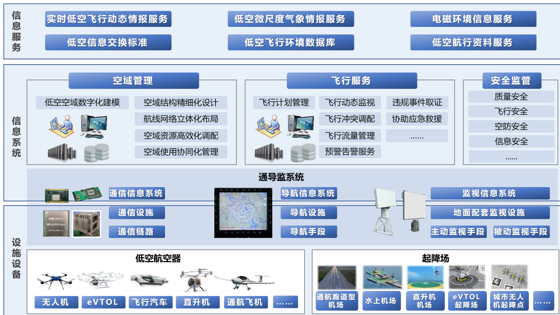
图 4 低空航行系统基本组成
