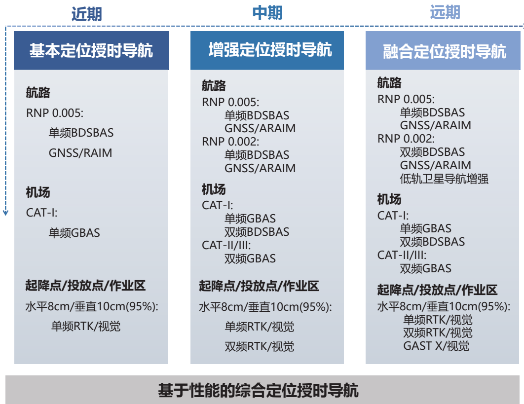
图 11 低空导航技术演进路线
